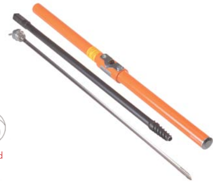
Pic. shows: Increment borer 'SUUNTO'
